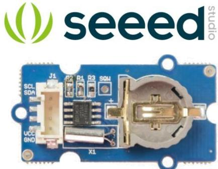
El RTC se basa en el chip de reloj DS1307 y es compatible con la comunicación I2C. Utiliza una batería de litio (CR1225). El DS1307 de bajo costo y eficiente en energía. Puede funcionar durante años con una batería muy pequeña.
