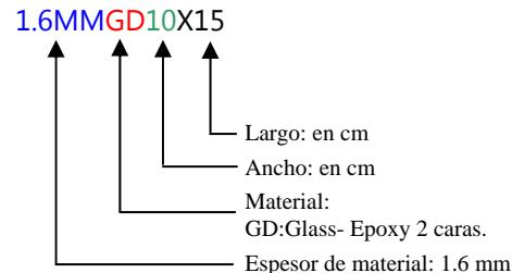
Lamina de cobre 1 Oz. (espesor 35um)
