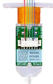
BL-touch con alta precisión y bajo consumo de potencia puede detectar automáticamente la nivelación y los datos precisos de salida. La desviación estándar es de sólo 0,0005mm, lo que hace que la nivelación sea más cómoda.
