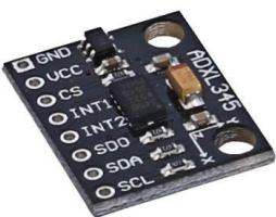
**Descripción:** El ADXL345 es un acelerómetro MEMS de 3 ejes con una resolución de 13 bits de hasta + -16 g. Los datos de salida digital están formateados como un complemento de dos dígitos de 16 bits y son accesibles a través de una interfaz digital SPI (3 o 4 hilos) o I2C.
