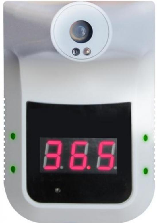
Cuenta con 3 salidas de señal digital cada una con un pulso de 5VCD y una corriente máxima de 100mA con una duración de 1.5 segundos
