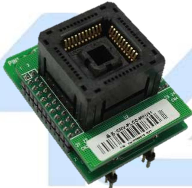
**Descripción:** Es un adaptador de PLCC a DIP51. Simplemente presione hacia abajo en la parte superior, coloque el chip con cuidado y luego baje la tapa para enganchar el chip. El chip se mantiene firmemente contra los pines en el zócalo.
