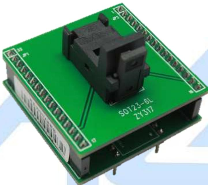
**Descripción:** Es un adaptador de PLCC para el SOT-23. Simplemente abra la tapa, coloque el integrado de manera correcta, hacia abajo y baje la tapa para enganchar el chip. El chip se mantiene firmemente contra el oro 'dedos' en el zócalo.
