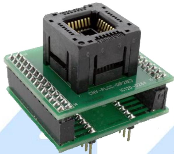
**Descripción:** Es un adaptador de PLCC para el DIP28. Simplemente presione hacia abajo en la parte superior, coloque el chip con cuidado y luego sueltelo para enganchar el chip. El chip se mantiene firmemente contra el oro 'dedos' en el zócalo.
