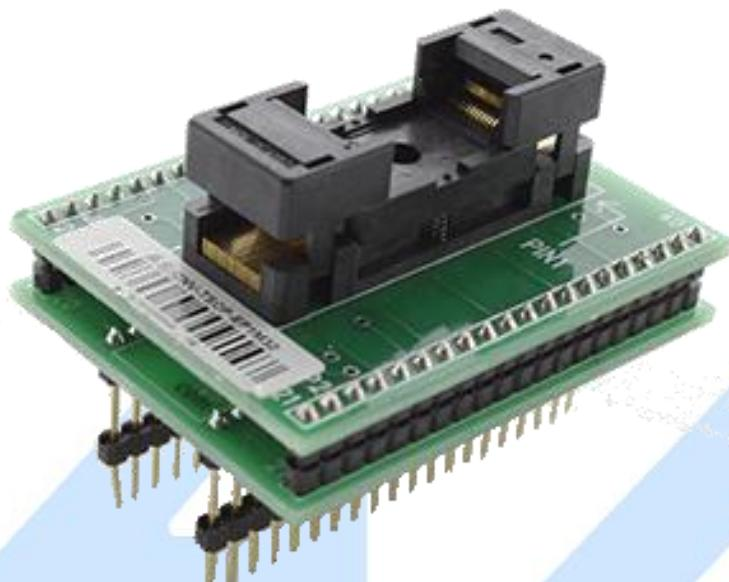
**Descripción:** Es un adaptador de TSOP-EP1M32 para el DIP28. Simplemente presione hacia abajo en la parte superior, coloque el chip con cuidado y luego sueltelo para enganchar el chip. El chip se mantiene firmemente contra el oro 'dedos' en el zócalo.
