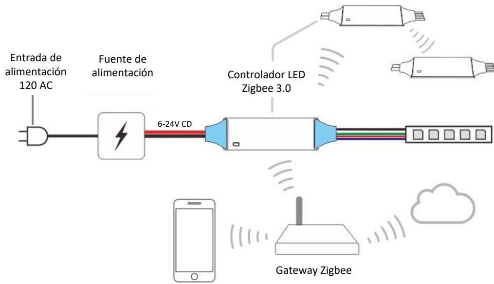
**Nota:** Se requiere de un Gateway con protocolo Zigbee 3.0 para su funcionamiento.
