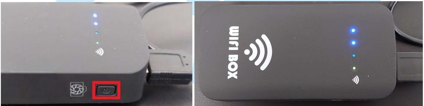
Para conectar el microscopio de forma inalámbrica, ir a la configuración de WiFi, seleccionar la red WIFImage\_7E33 para vincularlo
