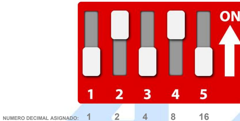
El número de canales posibles que puede proporcionar un interruptor DIP dependerá del número de interruptores que tenga, máximo pueden existir 32 canales para el switch de 5 posiciones (La dirección correcta de ON se indica en el encapsulado).
