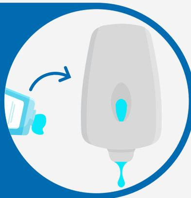
Si los equipos permanecen inactivos por un largo periodo de tiempo, se recomienda vaciar el tanque para evitar que el gel se seque y tape los conductos.
