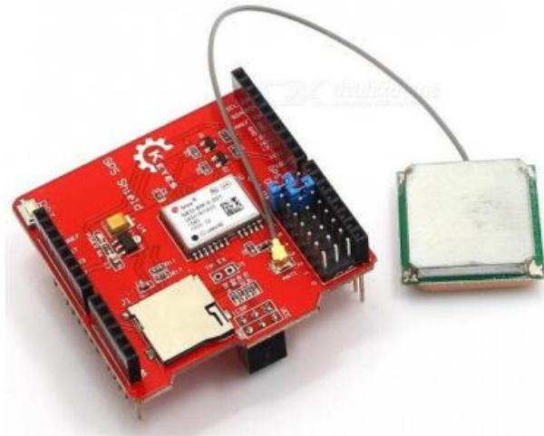
**Descripción:** Módulo GPS para Arduino basado en el módulo GPS NEO-6-blox. Sus pines TX, Rx pueden conectarse a los Pines digitales del Arduino.
