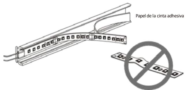
Corte la tira led a la longitud deseada cortando a lo largo del área marcada entre los pads de soldadura.
