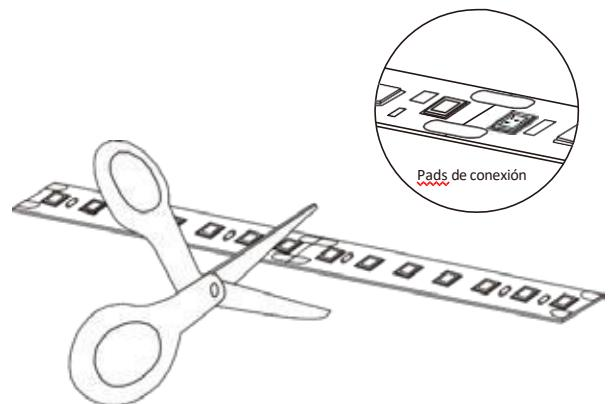
La tira LED se puede cortar con un par de tijeras en los lugares marcados entre los pads de soldadura. Consulte la hoja de datos del producto para conocer las longitudes de corte exactas. Siempre corte desde el extremo sin conectores ni cables.
