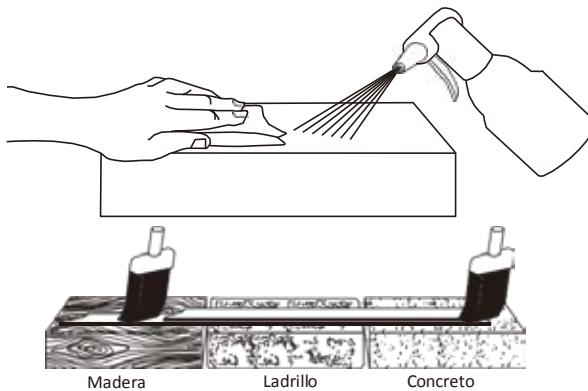
Limpie la superficie con una solución de alcohol 50/50 para proporcionar una superficie de montaje limpia, libre de aceites, siliconas y partículas de suciedad. Para materiales porosos como madera, ladrillo u hormigón, la limpieza de la superficie aumenta la duración de la fijación de la tira LED.
