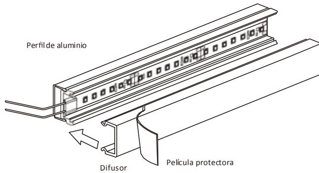
Coloque el difusor de acrílico en el perfil de aluminio y retire la película protectora del difusor.
