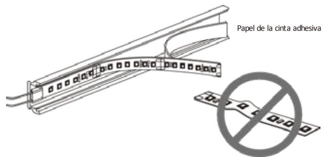
Corte la tira led a la longitud deseada cortando a lo largo del área marcada entre los pads de soldadura. Quite el respaldo de papel de la cinta adhesiva y presione firmemente hacia abajo sobre la superficie de aluminio. Desenrolle y pele una cantidad mínima a medida que lo instala para evitar la acumulación de escombros. El desenrollado y despegado excesivos de la cinta crea ondulaciones y burbujas de aire en la cinta que deben evitarse.
