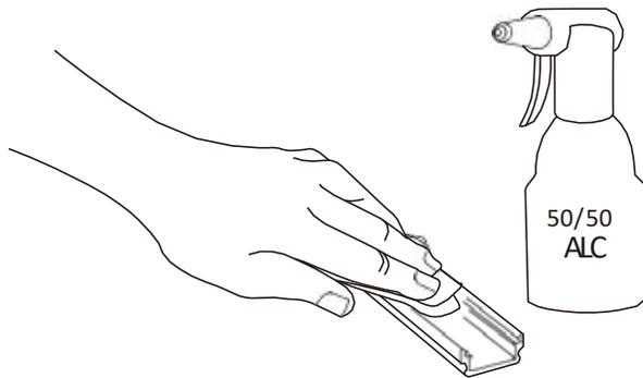
Limpe el perfil de aluminio donde se instalará la tira de LED. Con una mezcla de alcohol 50/50, y deje secar durante 5 minutos.
