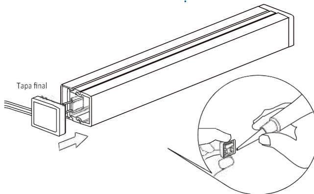
Pase los cables conductores a través o detrás de las tapas finales del perfil. Agregue pegamento (silicón caliente o frío o cualquier otro pegamento) dentro y alrededor de la tapa del extremo para asegurarla en su lugar, y presione hasta que la tapa esté fija.
