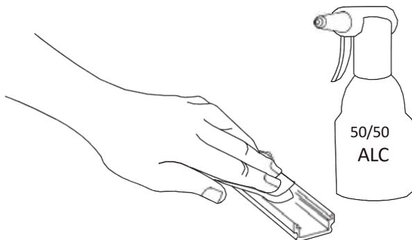
Limpie el perfil de aluminio donde se instalará la tira de LED. Con una mezcla de alcohol 50/50, y deje secar durante 5 minutos.
