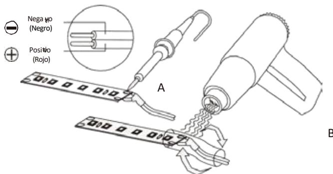
Los cables conductores se pueden soldar a la tira LED. Las conexiones de soldadura solo deben realizarse manualmente en los pads de soldadura que todas las tiras LEDs tienen distribuidos en cada línea de corte. El tiempo máximo de soldadura es de 3 segundos y la temperatura máxima de soldadura es de 350°C (662°F).
