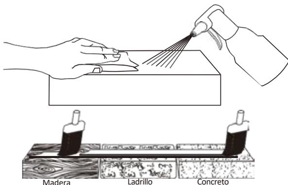
Limpie la superficie con una solución de alcohol 50/50 para proporcionar una superficie de montaje limpia, libre de aceites, siliconas y partículas de suciedad. Para materiales porosos como madera, ladrillo u hormigón, la limpieza de la superficie aumenta la duración de la fijación de la tira LED.
