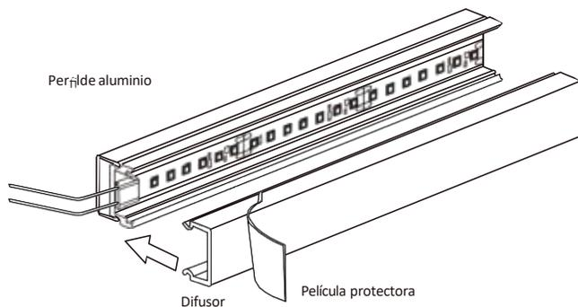
Coloque el difusor de acrílico en el perfil de aluminio y retire la película protectora del difusor.
