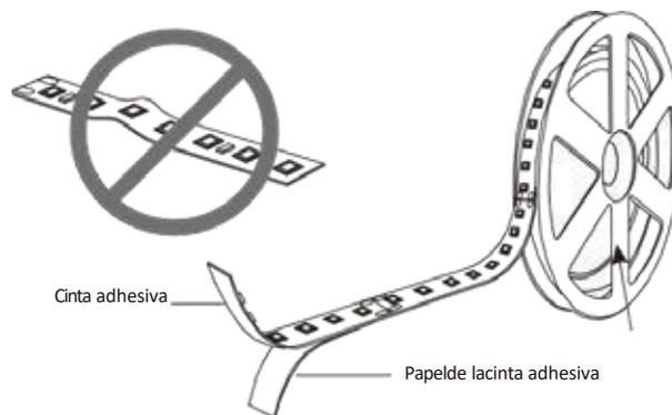
La tira LED solo debe montarse en superficies que proporcionen suficiente enfriamiento. Retire el papel de respaldo de la cinta y presione firmemente hacia abajo sobre la superficie. Desenrolle y pele la cantidad mínima de cinta mientras la instala para evitar la acumulación de escombros. El desenrollado y pelado excesivo crea ondulaciones y burbujas de aire en la cinta que deben evitarse.
