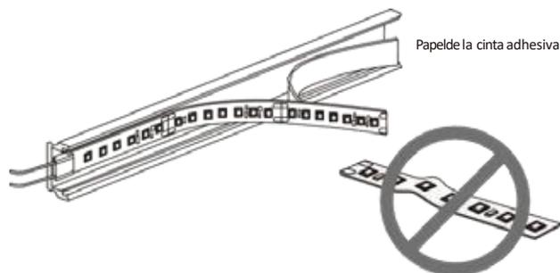
Corte la tira led a la longitud deseada cortando a lo largo del área marcada entre los pads de soldadura. Quite el respaldo de papel de la cinta adhesiva y presione firmemente hacia abajo sobre la superficie de aluminio. Desenrolle y pele una cantidad mínima a medida que lo instala para evitar la acumulación de escombros. El desenrollado y despegado excesivos de la cinta crea ondulaciones y burbujas de aire en la cinta que deben evitarse.
