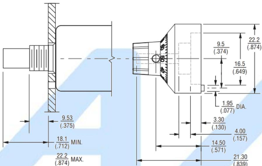
**Orificio para montaje del potenciómetro**
