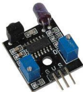
**Descripción:** El modulo de detección de objetos infrarrojos detecta fácilmente cuando hay obstáculos en la ruta con el detector IR. Detecta cuando los objetos están dentro del rango calibrado. Este dispositivo tiene 3 pines: Tierra (G), VCC (V) y Señal (S). La señal es digital, será alto o bajo, alto si el rango detectado es mayor que la distancia calibrada, bajo si el rango detectado es menor que la distancia calibrada.
