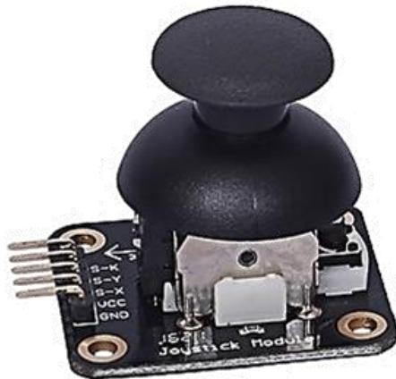
**Descripción:** El módulo joystick viene equipado con headers para conectarse fácilmente a una tarjeta de prueba para la creación rápida de prototipos. El joystick de dos ejes está equipado con potenciómetros independientes (uno por eje) para referencia analógica.
