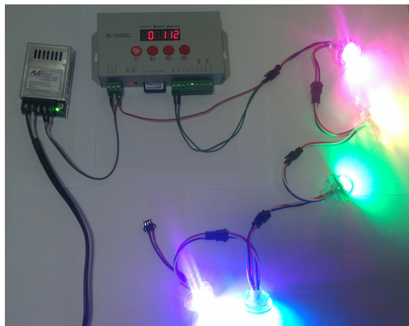
Figura 7. Funcionamiento Controlador- RGB/2048 con Display (K-1000C) velocidad 16
