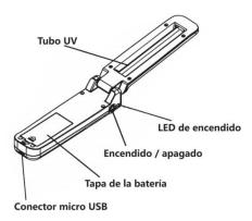
1. Abra la tapa de la batería empujando suavemente, hacia la dirección indicada
