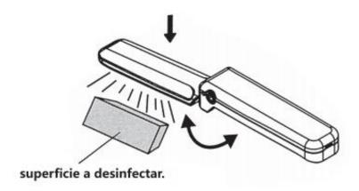
6. El dispositivo se apagará automáticamente si la unidad se gira hacia arriba. Una vez terminado el proceso de esterilización, presione el botón de encendido/apagado para apagar el equipo.
