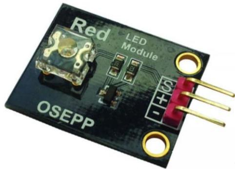
**Descripción:** El módulo LED permite una fácil configuración plug and play para las líneas de E / S de Arduino. El LED se puede controlar a través de una señal PWM o una salida digital alta / baja. 100% compatible con Arduino.
