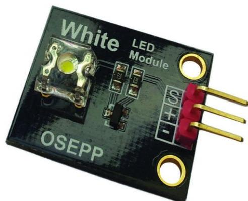
**Descripción:** El módulo LED permite una fácil configuración plug and play para las líneas de E / S de Arduino. El LED se puede controlar a través de una señal PWM o una salida digital alta / baja. 100% compatible con Arduino.
