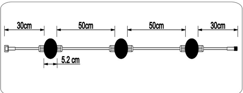
**NOTA:** El módulo viene por cantidad de 20 esferas, con conector macho y hembra incluido.
