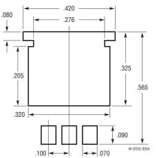
COPPER HEAT SINK RECOMMENDED SOLDER PAD LAYOUT - .420 -.350 .565 .090 .100 🔫 .070
