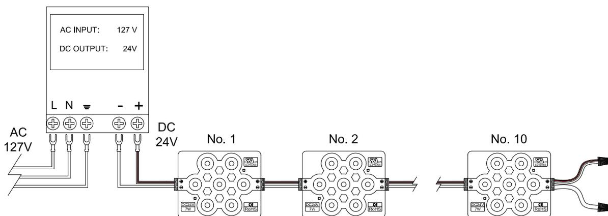
**Nota:** Asegurarse de conectar correctamente la salidas "V+" y "V-" de la fuente de alimentación con los cables del módulo correspondientes.
