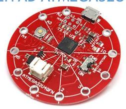
**Descripción:** Esta tarjeta contiene un puerto serie USB y un puerto serie virtual on-chip. Está desarrollado para dispositivos portátiles y textiles electrónicos. Cuenta con un procesador USB ATmega32U4. Los puertos de interfaz de comunicación son I2C como la comunicación que existe entre Arduino LilyPad USB y la PC. La tarjeta también proporciona la interfaz para baterías de litio portátiles.
