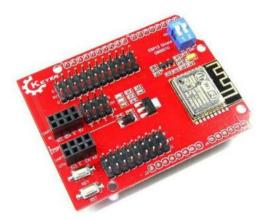
**Descripción:** con este escudo WiFi es posible conectar el Arduino a internet de forma inalámbrica. El escudo simplifica la comunicación WiFi de la tarjeta Arduino, sin embargo se puede utilizar con otros microcontroladores. Utiliza la norma 802.11b/g/n.
