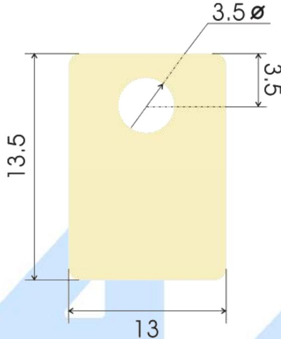
**Descripción:** Es una mica aislante para el transistor de encapsulado tipo TO-220, fabricada en fibra de vidrio para proporcionar aislamiento eléctrico.
