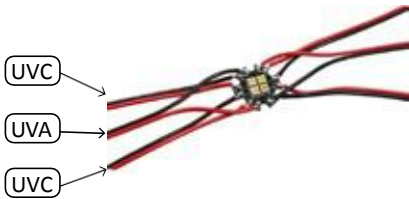
Fig. 6. MODULO-UVCA-2W-285/405NM. Los cuatro pares de cables de los extremos son la conexión positiva (cable rojo) y negativa (cable negro) para cada uno de los LEDs UVC. Los dos cables centrales son la conexión positiva (cable rojo) y negativa (cable negro) para cada uno de los LEDs UVA.
