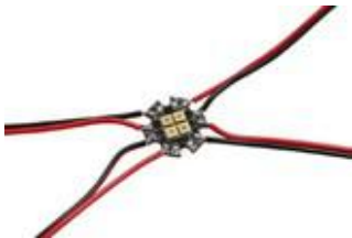
Fig. 5. Modelo MODULO-UVC-4W-265-285NM. Los cuatro pares de cables de los extremos son la conexión positiva (cable rojo) y negativa (cable negro) para cada uno de los LEDs UVC.
