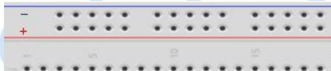
Las secciones internas o pistas son la superficie de la protoboard donde se conectan la mayoría de componentes del circuito.
