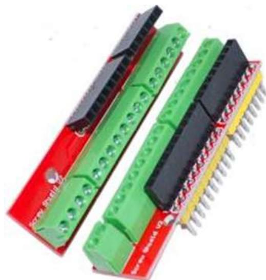
**Descripción:** Este Shield sirve para expandir las interfaces de entradas y salidas para su ARDUINO, permita conectar cables sujetándolos fijamente mediante sus borneras atornillables.
