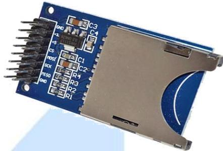
**Descripción:** Este módulo permite facilitar el uso de una tarjeta de memoria SD controlada con Arduino. A través de la programación, se puede leer y escribir en la tarjeta, además se puede utilizar como reproducción de archivos de audio como MP3, control de MCU, ARM. La Salida de los pines SD por SPI: MOSI, SCK, MISO y CS.
