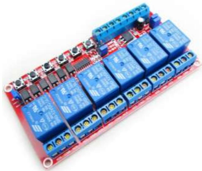
**Descripción:** Módulo de relé de 6 canales, puede ser controlado directamente por una amplia gama de microcontroladores como Arduino, PIC, AVR, ARM, DSP, etc. El auto bloqueo consiste en hacer clic, el relé y luego hacer clic en el relé apagado. 6 vías de auto bloqueo independientes entre sí, también puede agregar el interruptor de gatillo (bloques de terminales CH), con disparador alto o bajo (opcional), puede controlar simultáneamente 6 vías, como control de iluminación, etc.
