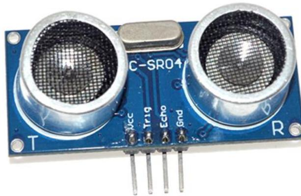
**Descripción:** Sensor de distancia por ultrasonido, capaz de detectar objetos y calcular la distancia a la que se encuentra en un rango de 2 a 450 cm. El sensor funciona por ultrasonido y contiene toda la electrónica encargada de hacer la medición.
