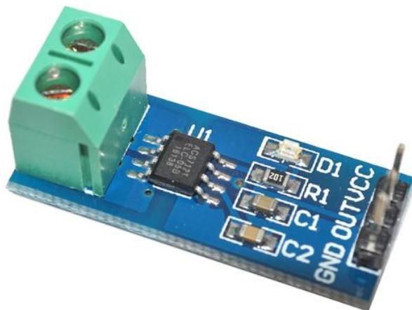
**Descripción:** Este módulo es compatible con arduino. Nos da una detección de corriente de 5A de acuerdo al sensor de arduino.
