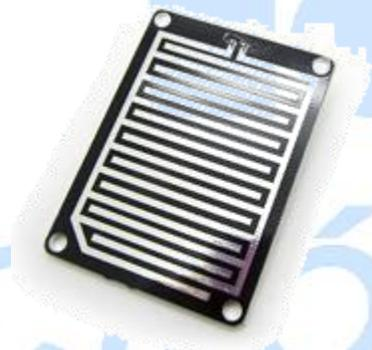
Tiene una placa de control (PCB) es el que posee las resistencias limitadoras de corriente y es el encargado de alimentar al sensor. Posee un amplificador operacional, el circuito integrado LM392, encargado de amplificar el pequeño diferencial de voltaje que se genera cuando una gota de agua cae sobre las pistas del módulo. Aquí es donde se genera la señal de salida que puede ser del tipo analógica o digital.
