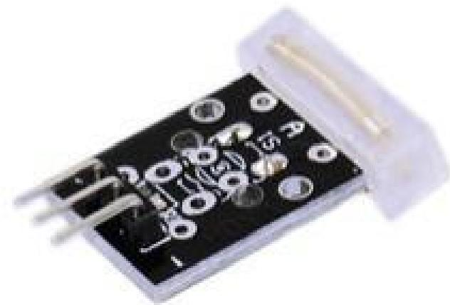
**Descripción:** Este sensor detecta las vibraciones de los impactos que esten sujetos a él, esta señal es enviada por un pin del módulo y puede ser procesada por cualquier microcontrolador o tarjeta Arduino.
