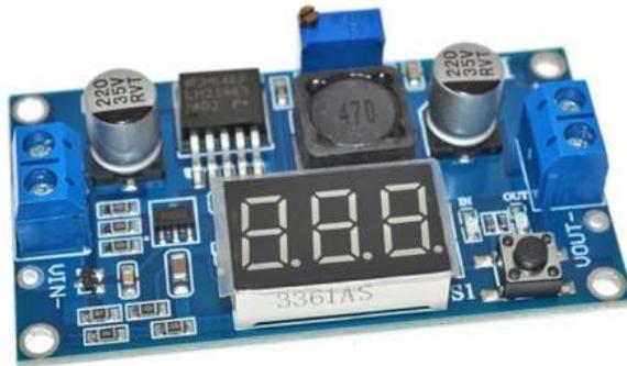
**Descripción:** Módulo regulador de voltaje con display, los cables de entrada y salida se pueden conectar con un destornillador. El display muestra la tensión de salida, misma que puedes modificar ajustando el potenciómetro de tornillo.
