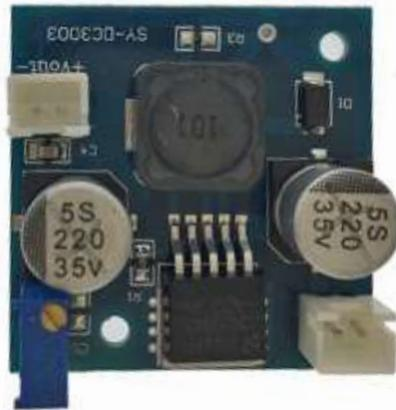
**Descripción:** Módulo de potencia ultra compacto con condensadores e inductores de alta potencia. La PCB de este modulo es de vidrio de doble cara y componentes de montaje de superficie de alta calidad seleccionados aseguran que el circuito sea más seguro.
