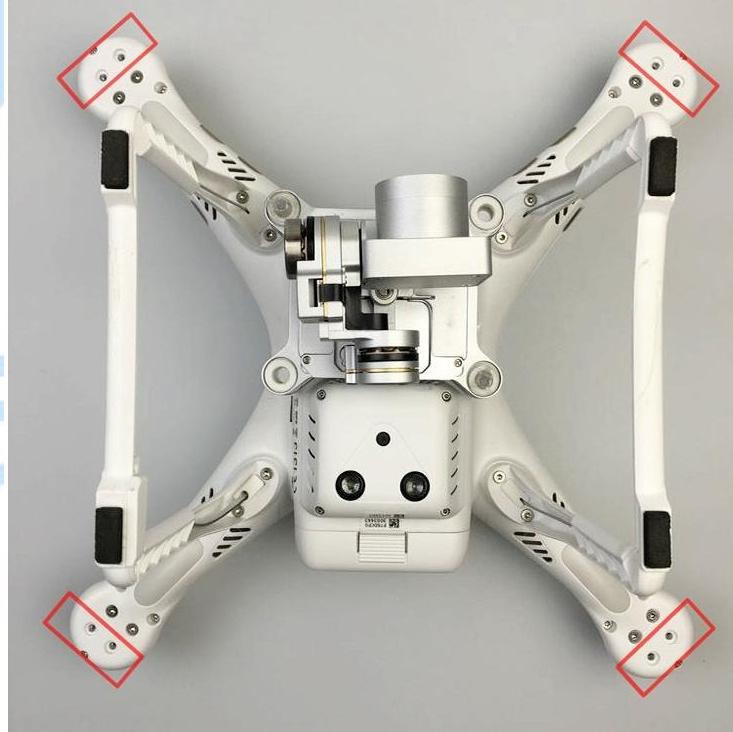
2. Instale las 4 bases en cada motor ("H" corresponde al motor negro y "B" al motor plateado)
