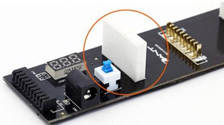
Si solamente carga 1 batería coloquela en el conector del extremo derecho marcado como **CN4**.
