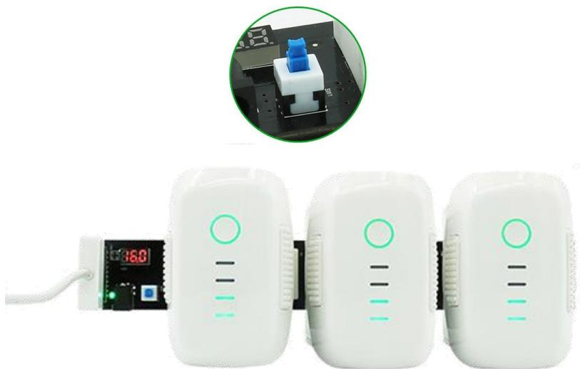
Mantenga el conmutador azul en la posición **OFF** si usa el cargador una fuente de poder alterna para alimentar la tarjeta de carga paralela.
