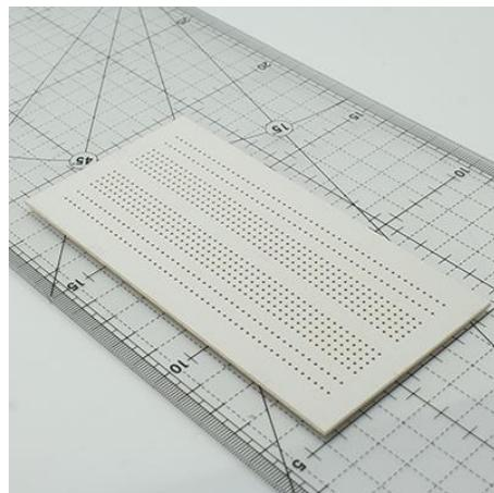
**Descripción:** Placa perforada para proyectos electronicos y prototipado. contiene una cara con cobre para poder soldar los elementos electronicos. esta placa esta diseñada como un protoboard para un uso mas facil.
