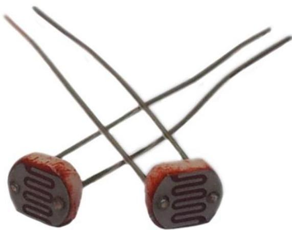
**Descripción:** El sensor de luz puede detectar variaciones en condiciones de luz. Las lecturas de entrada de luz son directamente proporcionales al voltaje de salida de los sensores de luz, se usa generalmente en condiciones ambientales donde se necesita medir la iluminación (LUX) como teléfonos, cámaras, sistemas de seguridad, juguetes.
