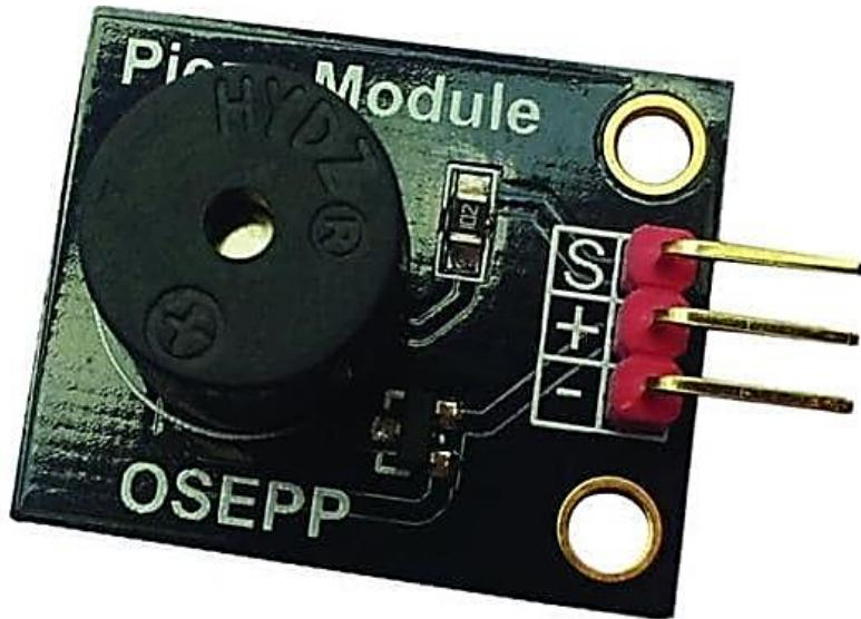
**Descripción:** El modulo actúa como un dispositivo zumbador de salida y un dispositivo de entrada que mide la presión del sonido.
