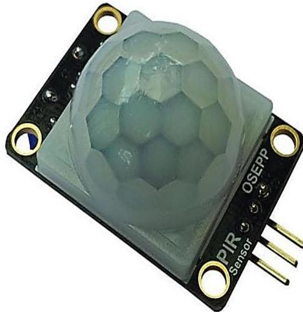
**Descripción:** El sensor de detección de movimientos detecta cambios en el movimiento dentro de su entorno, es compatible con Arduino.
