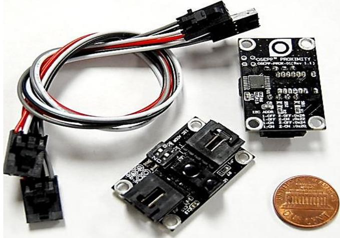
**Descripción:** El módulo de sensor de proximidad OSEPP mide las distancias. Utiliza la unidad de sensor de medición Sharp GP2Y0D805Z0F que se compone de una combinación integrada de fotodiodo, diodo emisor de infrarrojos, Este módulo es ideal para diseños que necesitan detectar objetos dentro de un cierto rango o diseños que necesitan evitar obstáculos. También se puede usar como un interruptor sin contacto.
