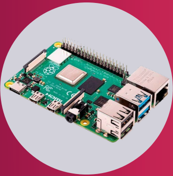
Raspberry Pi 4 Modelo B+ con 4GB RAM.
